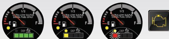
La jauge indique le niveau de liquide d'échappement du diesel (LED) dans le réservoir et émet une série d'alertes lorsque celui-ci commence à se vider. Un conducteur qui ignore les avertissements de faible niveau de LED verra des déclassifications et des restrictions sur son véhicule, mais il ne sera jamais en détresse. **Il suffit de surveiller la jauge. C'est tout simple!**
