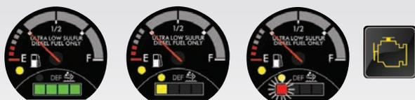
La jauge indique le niveau de liquide d'échappement du diesel (LED) dans le réservoir et émet une série d'alertes lorsque celui-ci commence à se vider. Un conducteur qui ignore les avertissements de faible niveau de LED verra des déclassifications et des restrictions sur son véhicule, mais il ne sera jamais en détresse. **Il suffit de surveiller la jauge. C'est tout simple!**
