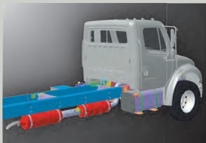
TUYAU D'ÉCHAPPEMENT SIMPLE SOUS CABINE
