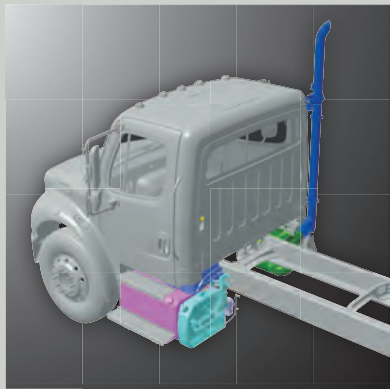
TUYAU D'ÉCHAPPEMENT SIMPLE À L'ARRIÈRE DE LA CABINE
